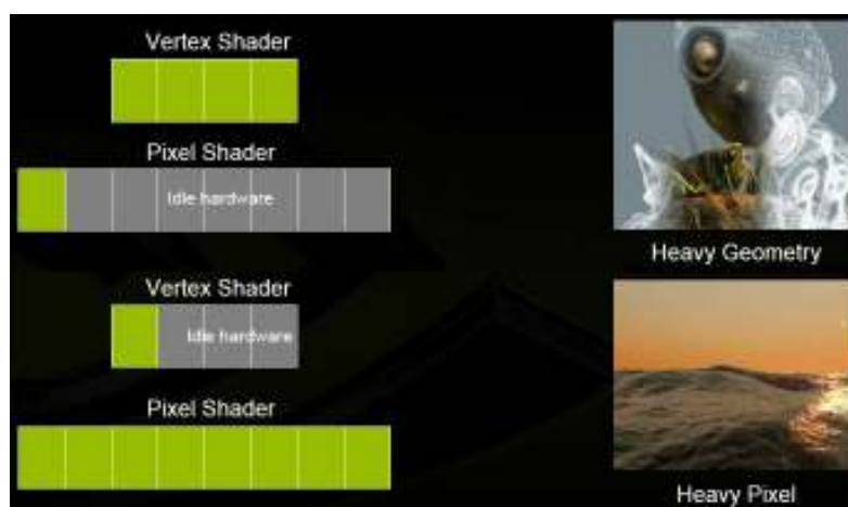
تصویر ۱۲- بار گرافیکی نابرابر روی مراحل مختلف خطلوله باعث بیکار ماندن برخی از واحدها می‌شود. (تصویر از منبع
